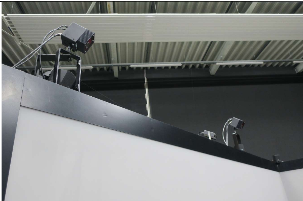
Poutre supérieure – écran de gauche – avec 2 caméras de tracking et un boîtier émetteur
