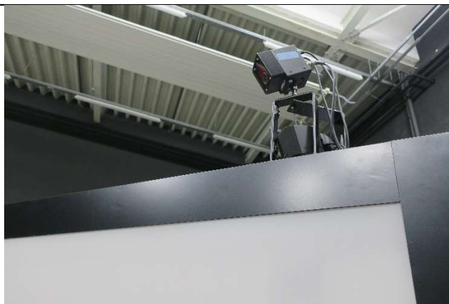
Renfort du maintien de la poutre verticale de l'écran de gauche (vue arrière)
