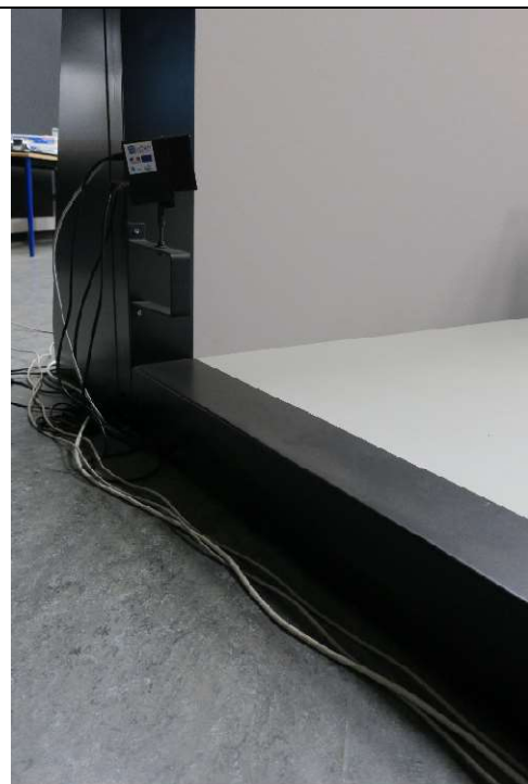
Vue de l'assemblage de l'écran de gauche et du sol métallique
